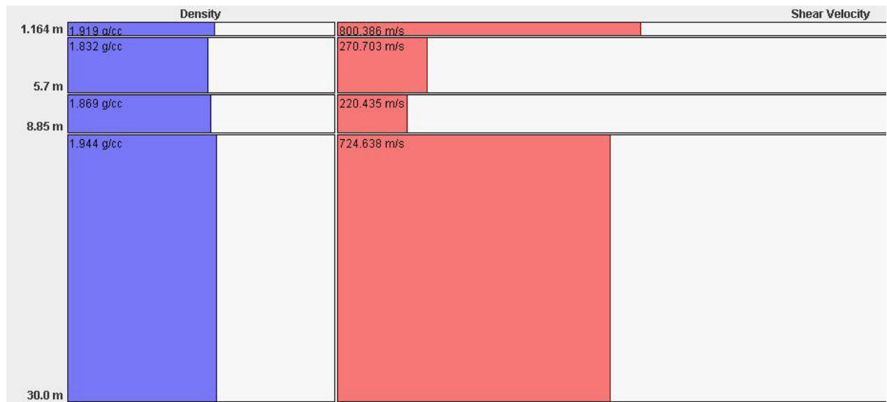
Figura A: Stendimento 2. Andamento delle onde di taglio ( V_s ) fino alla profondità di 30 m dal p.c.
