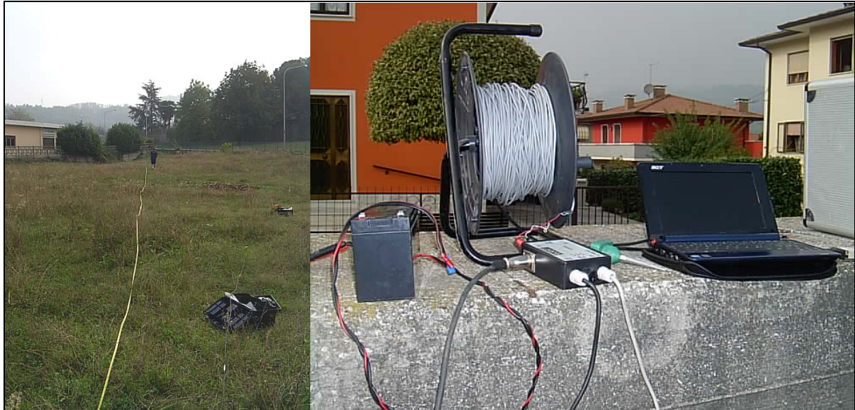
Prospezione sismica in onde S con la tecnica dei microtremori
